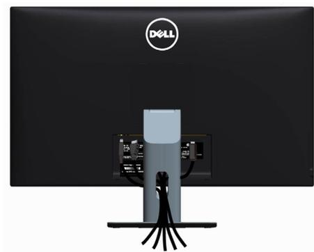
После подключения всех необходимых кабелей к монитору и компьютеру (Сведения о подключении кабеля см. в разделе «[Подключение монитора](#)») сгруппируйте все кабели как показано выше.
